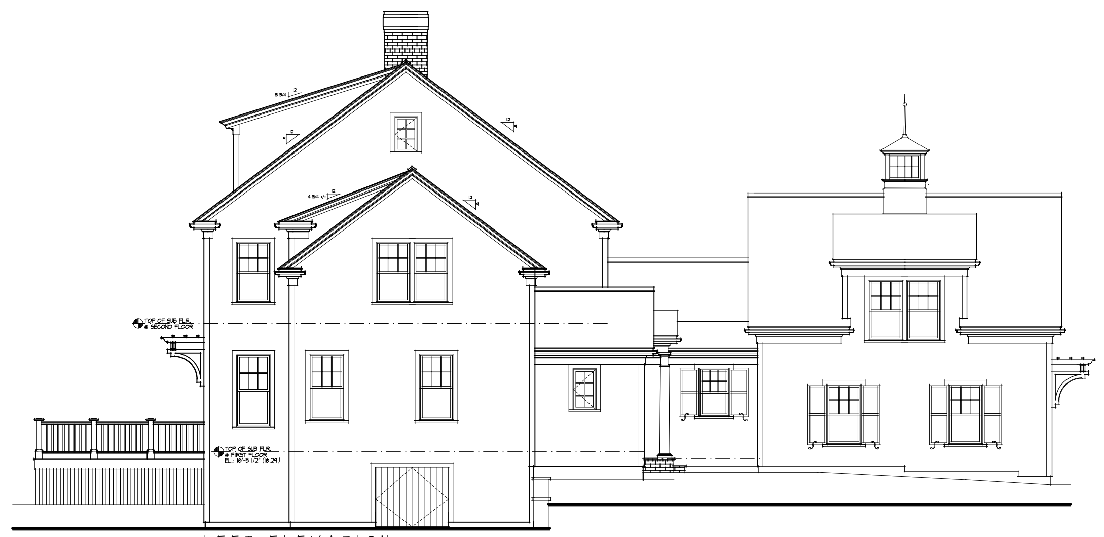
LEFT ELEVATION SCALE: 1/4" = 1'-0"
